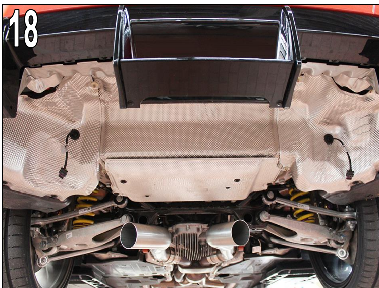
Abb. 18 Hitzeschutzbleche wieder montieren und die AC Schnitzer Kabelsatzstecker für die Abgasklappenmotoren mit den Serienkabelbaumsteckern verbinden.
